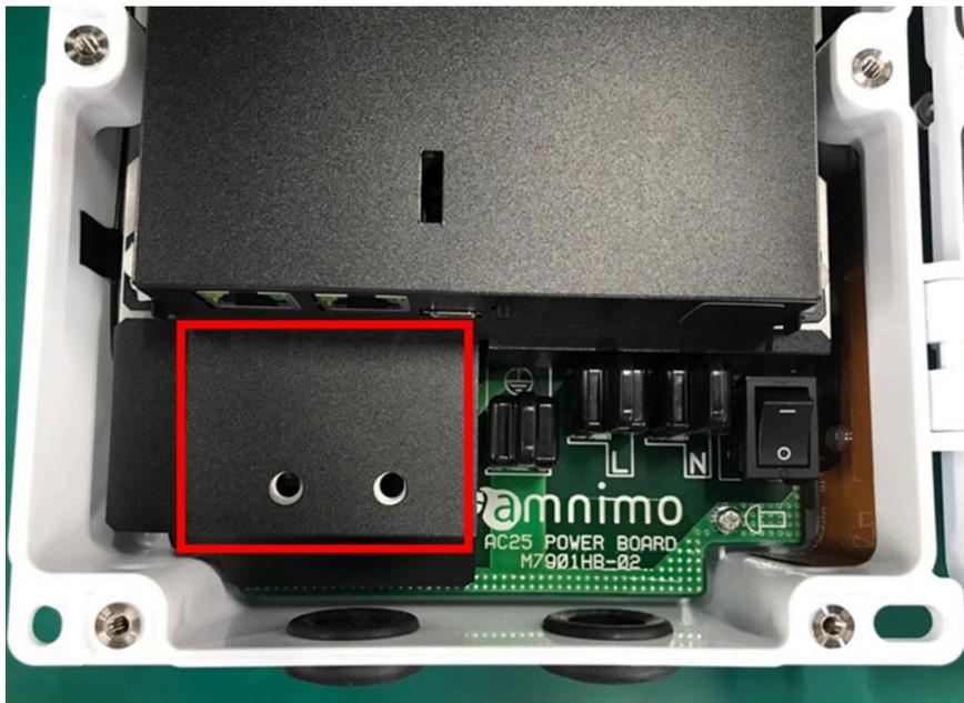
2 電源ケーブルおよびLANケーブルを接続し、ケーブルクランプで長さを調整してください。
