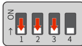
Linux 起動モードの DIP スイッチ設定
